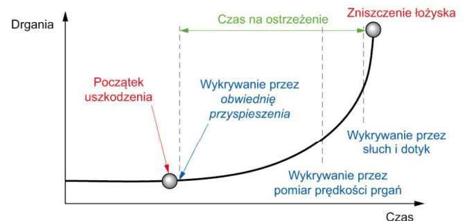
Rys. 29. Wynik pomiaru drgań węzła łożyskowego przykładowego silnika w napędzie przemysłowym (idea diagnostyki drganiowej stanu technicznego łożyska tocznego w silniku) [222]
