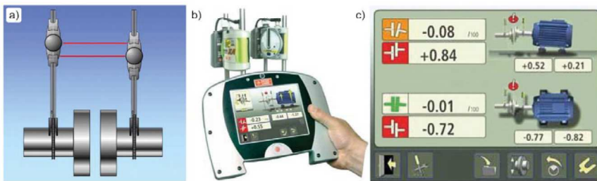
Rys. 18. Jeden z najnowszych układów laserowych do osiowania:
