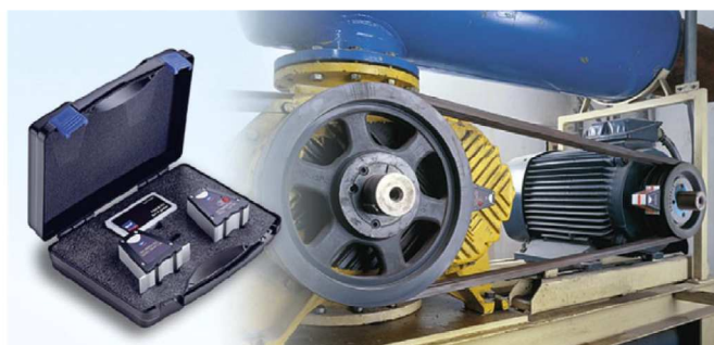
Rys. 22. Laserowa aparatura do ustawiania przekładni pasowych [231]
